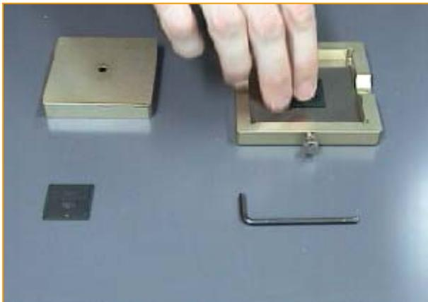
Legen Sie das Bauteil so auf die Schablone dass die Kugeln des Bauteils in die Löcher der Schablone passen.
