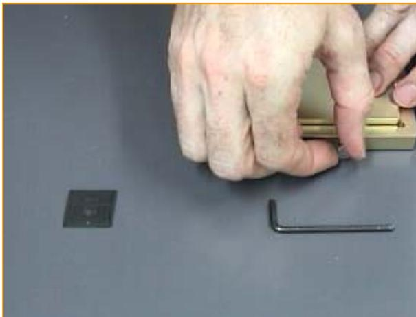
Die Rändel Schraube im Basis-Rahmen muss jetzt noch fest angezogen werden um die beiden Teile zu fixieren.
