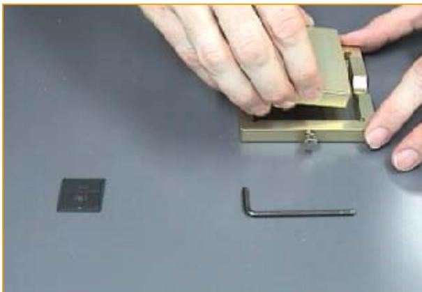
Legen sie jetzt den universellen Abschluss Deckel mit dem Loch der Halte-Schraube im Zentrum nach oben in den Basis-Rahmen.
